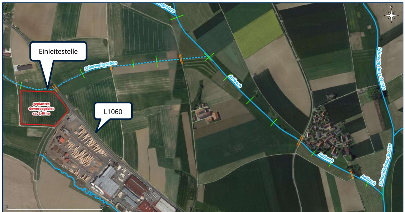
Abbildung 4: Aufgenommene Gewässerprofile des Scherweidgrabens und des Aalbachs (grün: offene Profile; orange: geschlossene Profile) (Quelle Luftbild: www.earth.google.com )
