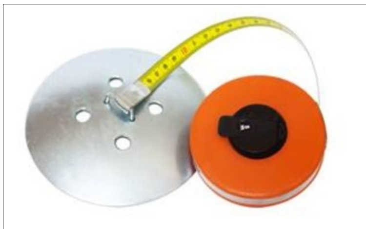
Bild 4-4: Schlammteller zur Messung der Schlammhöhe (Quelle: Börder GmbH, 56743 Mendig)
