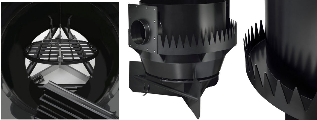
Bild 2-2: Links: Strömungsrichter im Zulaufbereich mit unten liegendem hochgeklapptem Strömungsbrecher; Mitte: Zulauf und Gesamtanlage; rechts: Zackenwehr von außen nach innen durchströmt in Richtung Ablauf des 3P Hydrosharks (3P Technik Filtersysteme GmbH, 2024)
